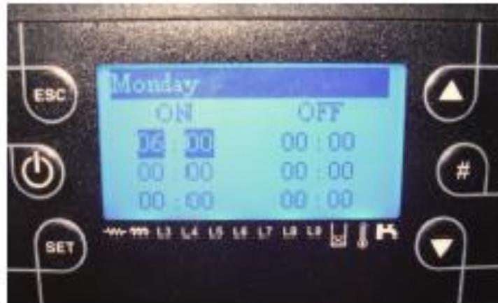
Drücken Sie die Taste P6, um zum Feld zu gelangen, in dem sie die Ausschaltzeit des Kamins eingeben. Drücken Sie die Taste P3 (das ausgewählte Feld blinkt) und stellen Sie die Ausschaltzeit mit der Taste P4 oder P6 ein.
