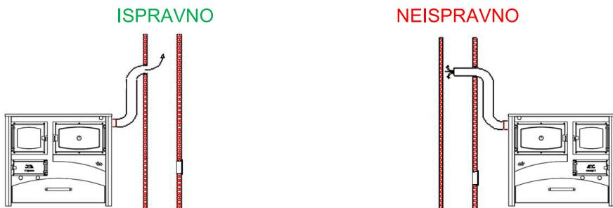
(Sl. 6) Spajanje dimovodne cevi (čunka) sa dimnjakom
